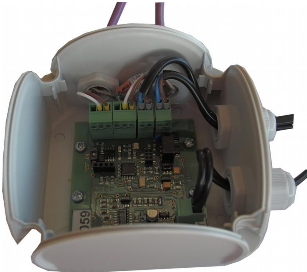
obr.8 zapojené konektory průběžné čtečky
