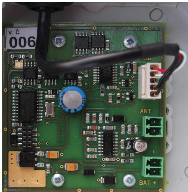
obr.6 plošný spoj čtečky USB
